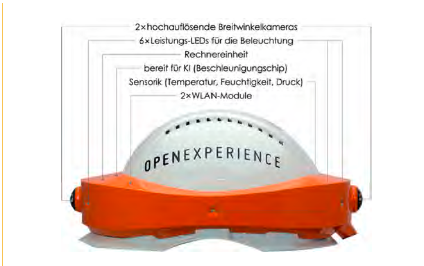
Abb. 01: Helmkamerasystem für 360-Grad-Bilddaten [Quelle: Open Experience GmbH]
