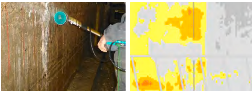
Abb. 07: Potentialfeldmessung an einem Wandssockel, Potentialkarte zur Abgrenzung von Bereichen hoher (rot-orange) und geringer Wahrscheinlichkeit aktiver Korrosion (grau) [Quelle: Dr.-Ing. Sebastian Schulze, bauray GmbH/hupfer ingenieure]
