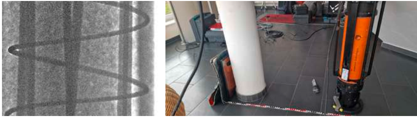
Abb. 12: Visualisierung der Wendel- und Vertikalbewehrung in einer Rundstütze per Radiographie (Röntgen) [Quelle: Dr.-Ing. Sebastian Schulze, bauray GmbH]
