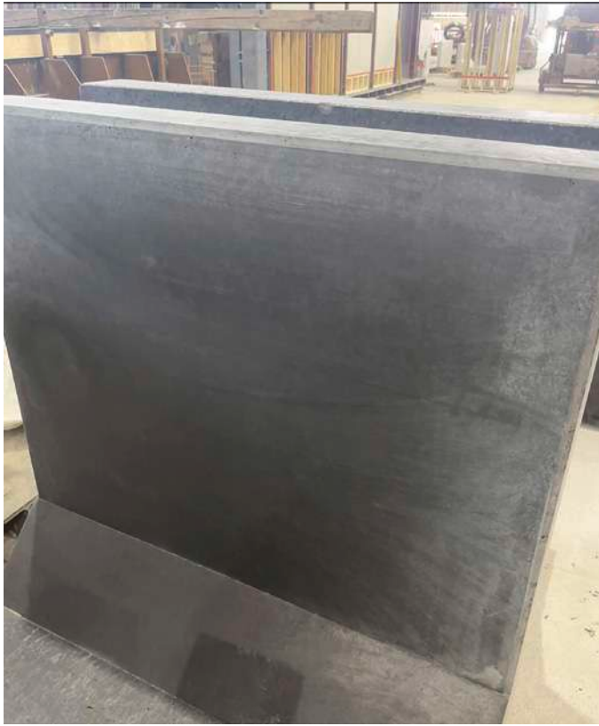
Abb. 02: Betonfertigteil der Firma Wilhelm Siemens GmbH u. Co. KG, das durch den Einsatz von Karbonisat \text{CO}_2 -negativ ist [Foto: Wilhelm Siemens GmbH u. Co. KG – Betonfertigteilwerk]
