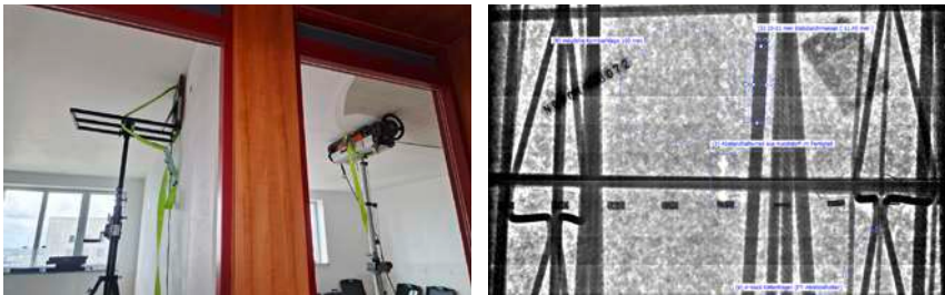
Abb. 05: Untersuchungsaufbau und Röntgenbild einer hochbelasteten Elementwand für das Anlegen von Kernbohrungen ohne Bewehrungstreffer und Fehlbohrungen: Erkennbar sind Bewehrungsstäbe, A-Böcke der Fertigteilchalen sowie Abstandhalter (Kunststoffräder). [Quelle: Dr.-Ing. Sebastian Schulze, bauray GmbH/hupfer ingenieure]
