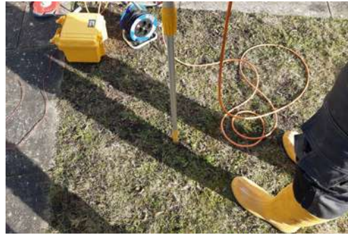
Abb. 02: Messequipment mit Messstab und dem Antasten auf einer Rasenfläche [Quelle: Texplor GmbH]
