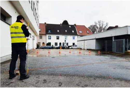
Abb. 01: Messtechniker beim Überprüfen der Außenabdichtung des darunterliegenden Kellers [Quelle: Texplor GmbH]
