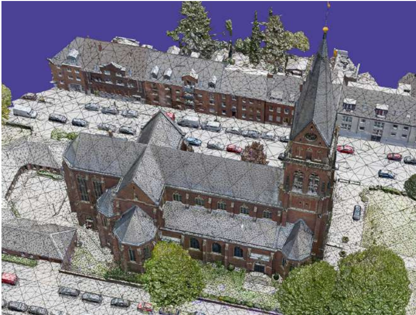
Abb. 02: Erkennbares 3-D-Mesh (vermaschtes Polygonen- / Drahtmodell)
