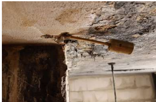
Abb. 07: Einspeisung / Tracer mit Tropfenbildung [Quelle: Texplor GmbH]
