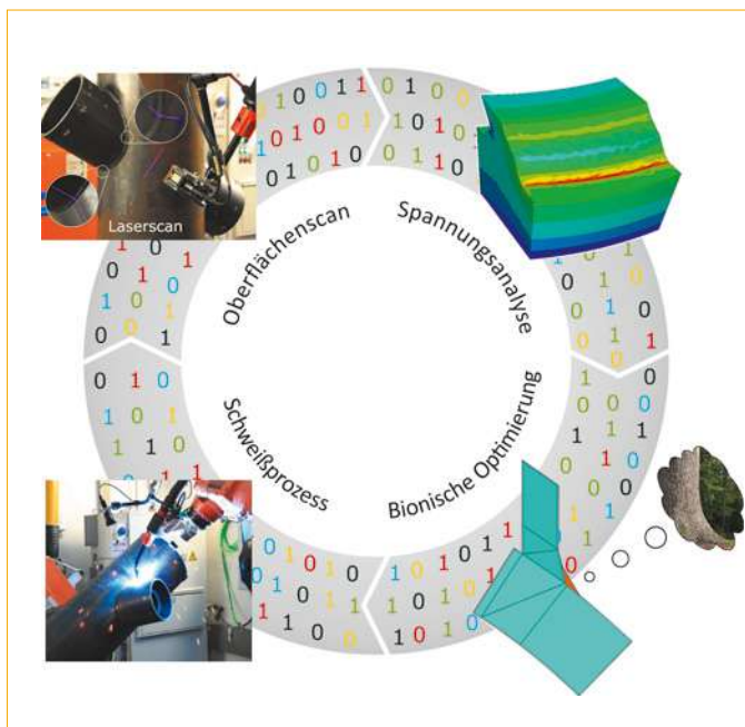
Abb. 07: Digitale Prozesskette zur bionischen Optimierung roboterfertigter Schweißnähte im schweren Stahlbau
