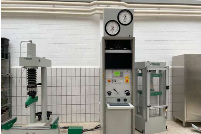
Abb. 05: Betonprüfanlage [Foto: Bau-ABC Rostrup]
