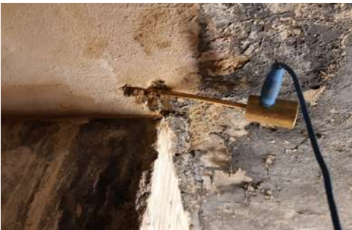
Abb. 04: Beispielhafte Platzierung der Einspeisung / Tracer in feuchter Leckage [Quelle: Texplor GmbH]
