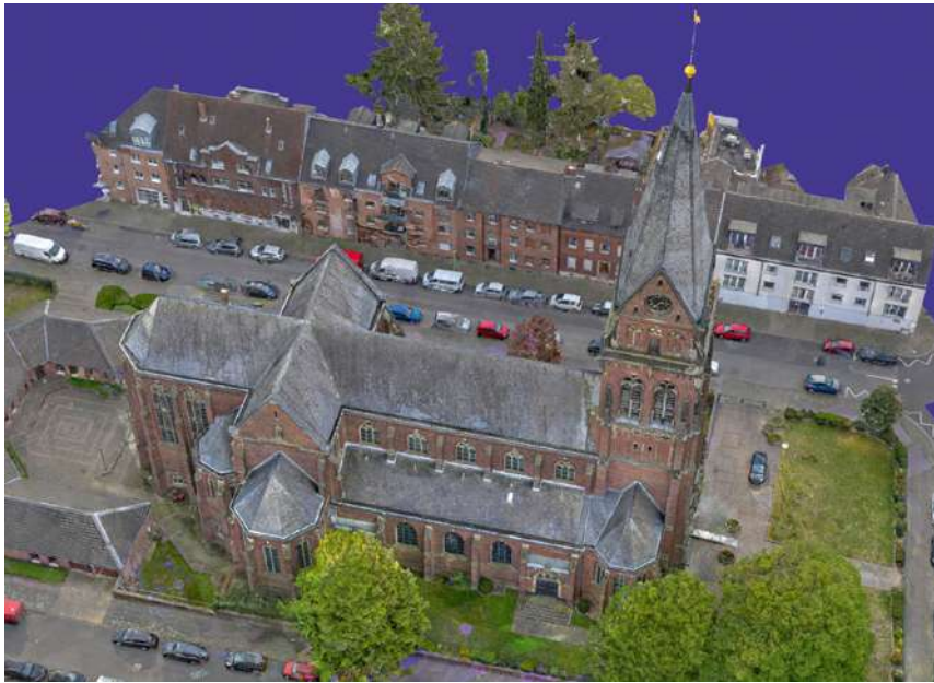
Abb. 03: Fotorealistische, auf einem digitalen Polygonmodell mit Texturen basierende Darstellung
