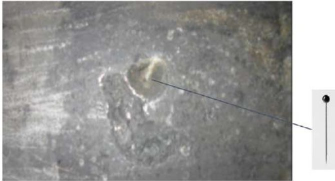
Abb. 04: Korrosionsschaden an einer anfangs nicht kathodisch geschützten Leitung mit Leck im Durchmesser-Bereich einer Stecknadel-Spitze.
