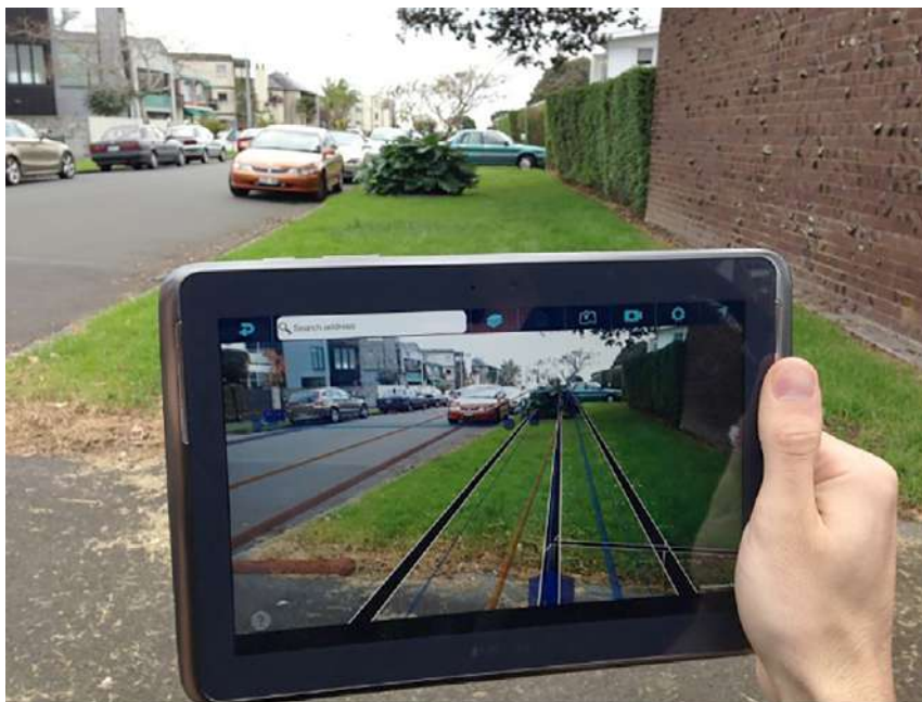
Abb. 02: Augmented Reality für Leitungsvisualisierung (erstellt mit dem AR-System AugView)
