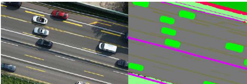
Abb. 08: KI-basierte Objekterkennung [STRABAG AG]
