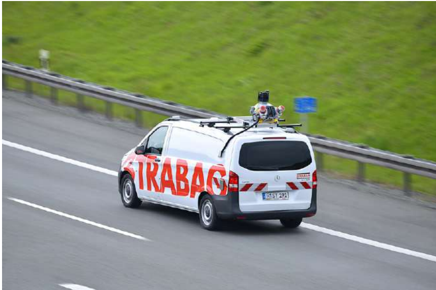
Abb. 02: Mobile Mapping-System im Einsatz auf deutschen Bundesautobahnen. [Thomas L. Fischer/STRABAG AG]
