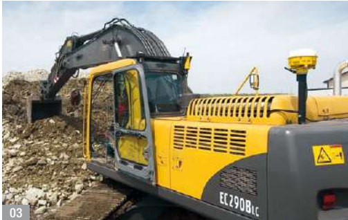
Abb. 03: Bagger mit Trimble GNSS [SITECH]
